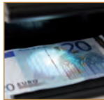
Con la luce bianca (lampadina LED da 0,3 watt) si verificano i segni e la filigrana della banconota.
